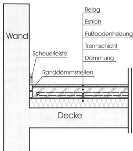
Abbildung 5: Fußbodenaufbau
