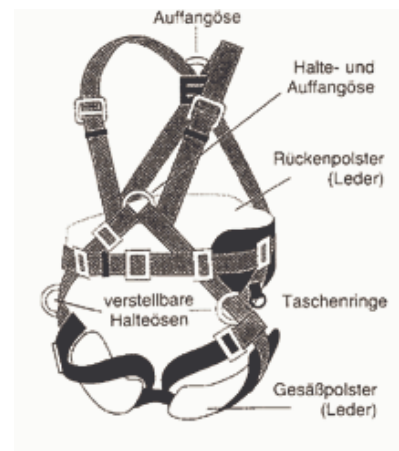
Abb. 8: Auffanggurt mit vorderer und rückseitiger Fangöse sowie seitlichen Halteösen
