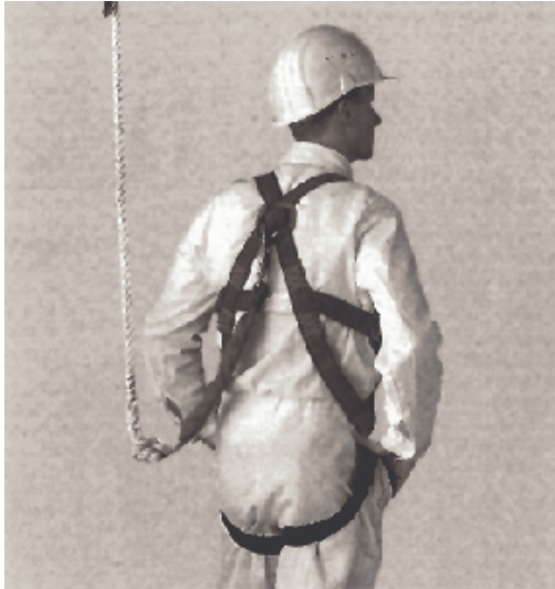
Bild 7: Beispiel der Benutzung des Auffangsystems Verbindungsmitel mit Falldämpfer und Auf- fanggurt
